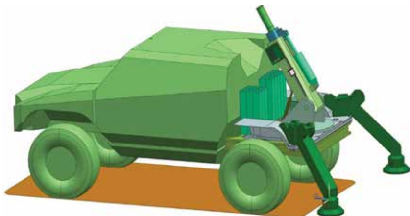
■ 120 mm vezený mínomet so zabudovanými hydraulickými podperami a spevneným rámom
